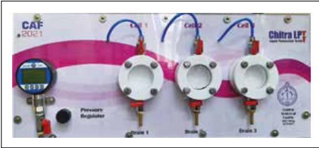
चित्र 61. सिंथेटिक खून प्रवेश परीक्षण के लिए चित्रा लिक्विड पेनेट्रेशन टेस्टर
