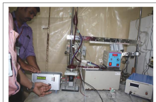
चित्र 18. रक्त का उपयोग कर विट्रो मूल्यांकन में केन्द्रापसारक रक्त पम्प
